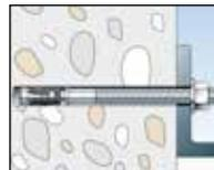
**Die Bohrlochreinigung** nach dem Bohren, z. B. durch Ausblasen, Ausbürsten oder Aussaugen, ist meist unerlässlich. Ein ungereinigtes Bohrloch reduziert die Tragfähigkeit! Das Bohrmehl beeinträchtigt die Tragfähigkeit des Dübels im Bohrloch. Abweichungen hiervon sind in den jeweiligen Dübelzulassungen angeben.
