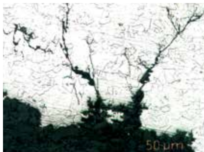
Primer transkristalne korozije, ki je posledica nateznih razpok v 1.4401 pri močnih obremenitvah s kloridom.
